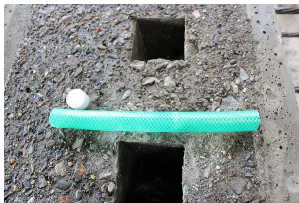
写真-5 ボンドレスホースの拡大写真
