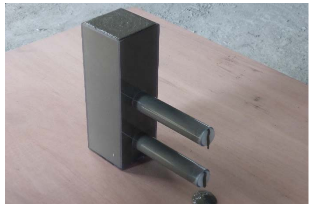
写真-18 無収縮モルタル充填確認試験
